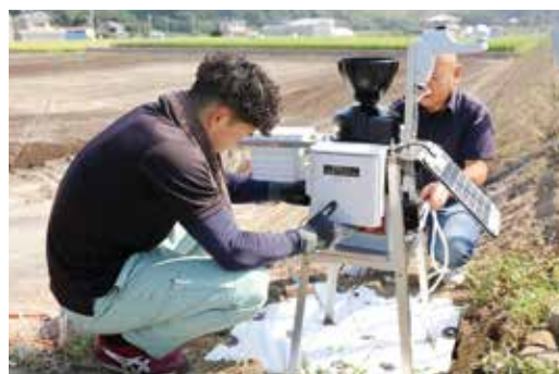
気象ロボットを設置する営農相談員
